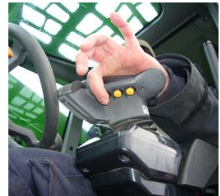
Induktionsschalter mit Hauterkennung gegen unbeabsichtigtes Bedienen
